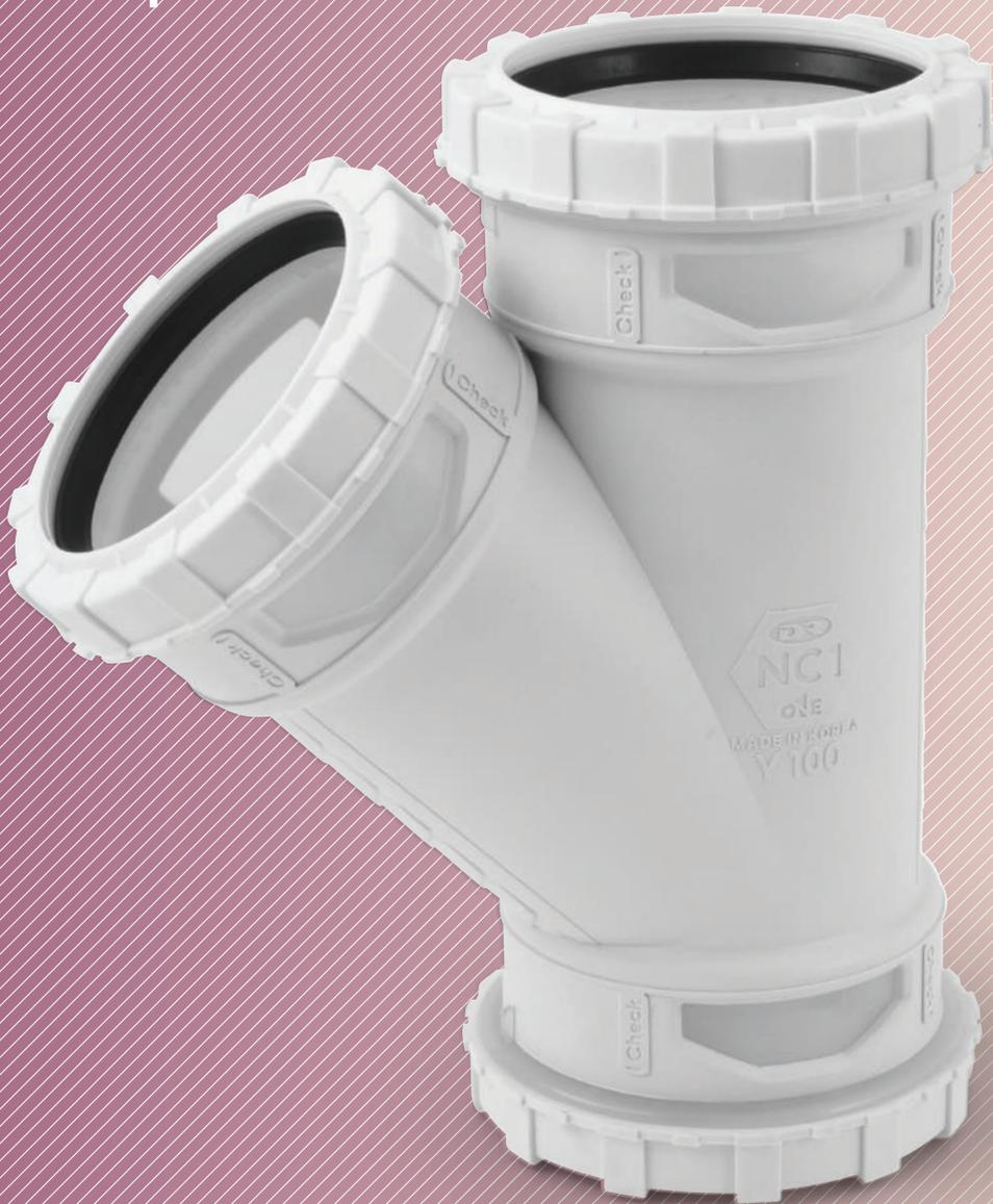
NC1은 투명 PP(Polypropylene) 및 연질 PVC 재질(차음층)를 사용한 이중구조와 차음 비늘무늬를 통해 소음감소 효과가 우수합니다. 투명점검창을 활용한 파이프 삽입성을 육안으로 확인가능하고 원터치 체결방식으로 더욱 편리한 시공 및 점검이 가능한 제품입니다.
